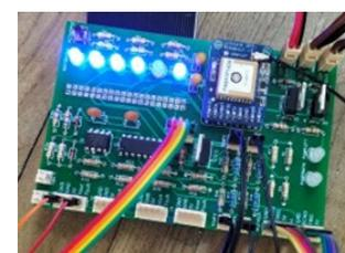
Placa circuito impresso para interligação dos sensores e eletrónica.
